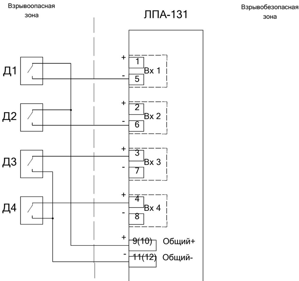
**Рисунок 3. Комбинированная схема подключения входных цепей барьера ЛПА-131**
