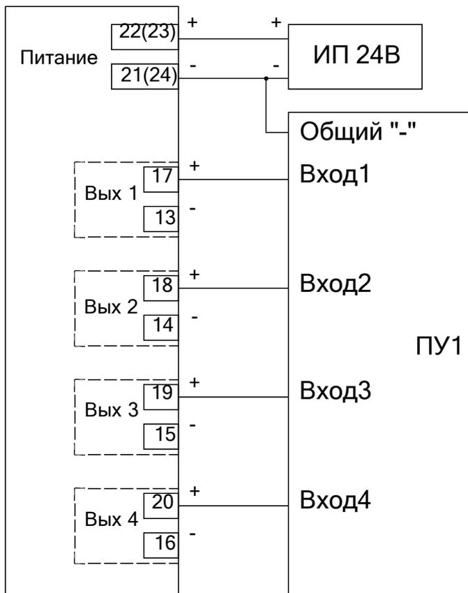
**Рисунок 5. Схема подключения выходных цепей барьера ЛПА-131 с использованием «верхних» выходных ключей**
