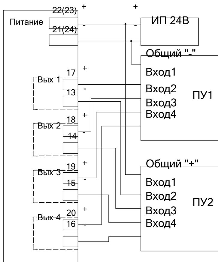
Рисунок 7. Схема подключения выходных цепей барьера ЛПА-131 с разветвлением сигнала
