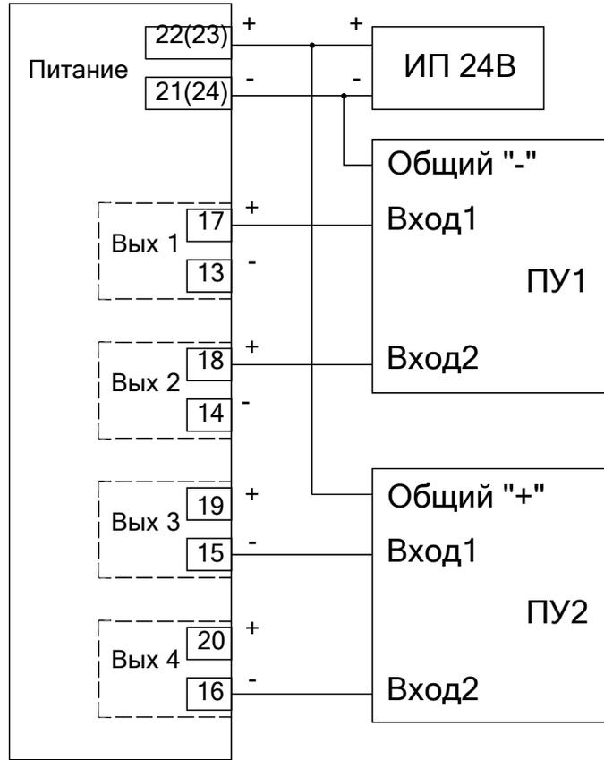
Рисунок 6. Комбинированная схема подключения выходных цепей барьера ЛПА-131
