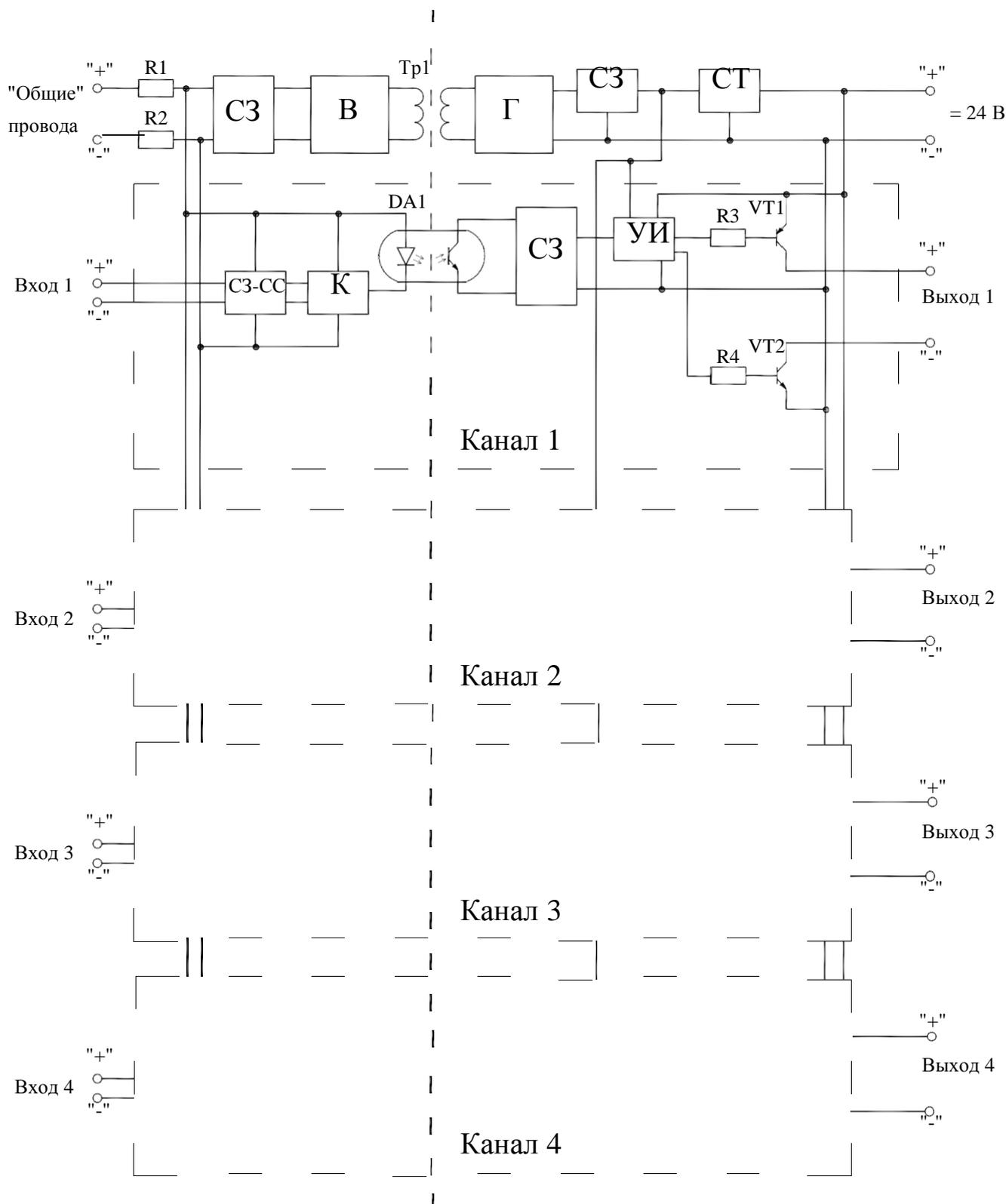
Рисунок Б.1 — Структурная схема барьера ЛПА-131-4ХХ
