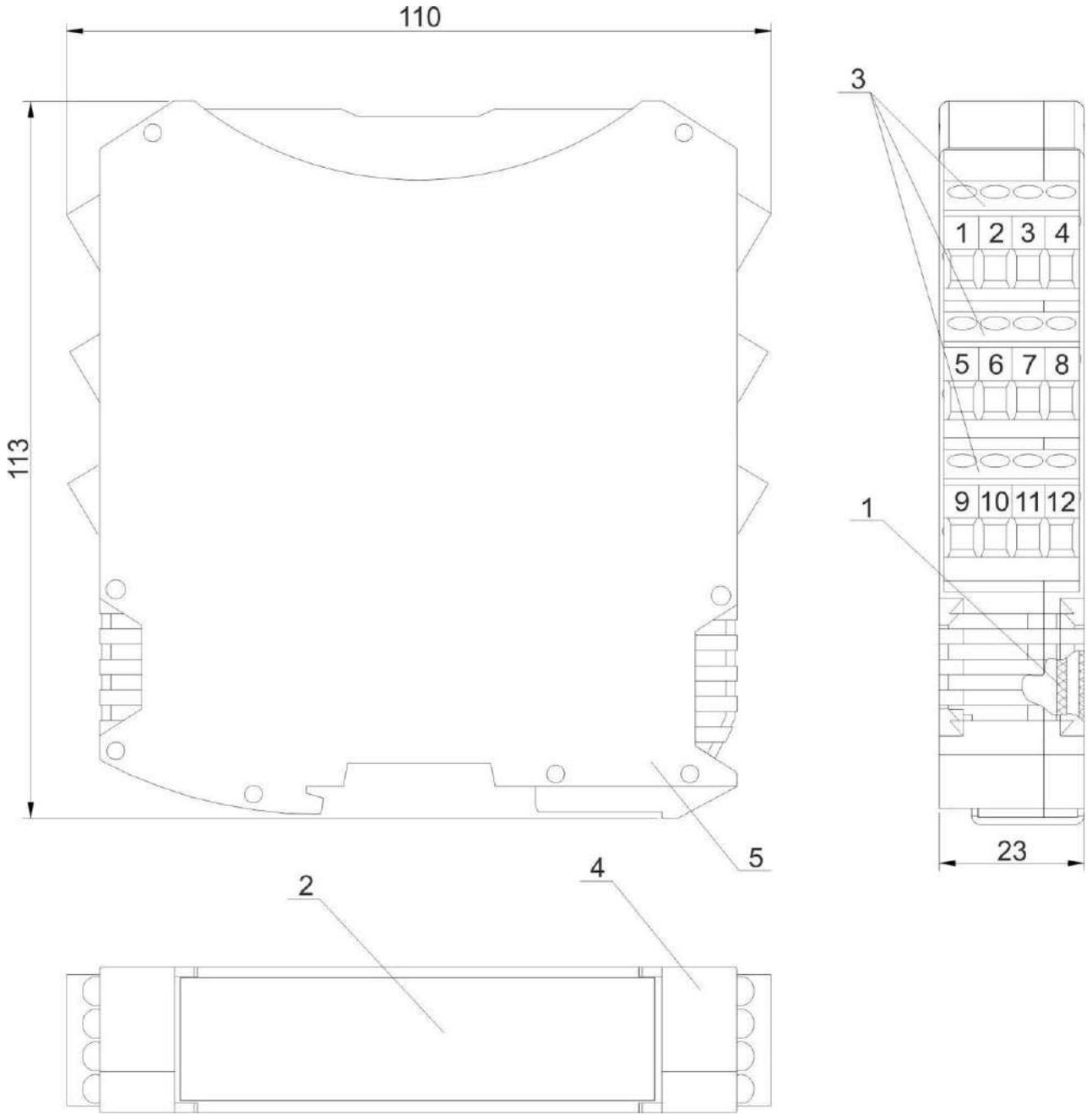
**Рисунок А.1. Конструкция барьеров ЛПА-131**
